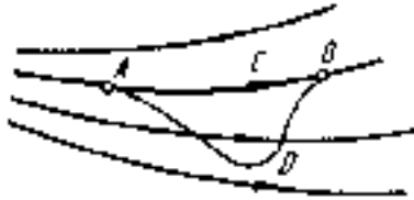
Figura 3.1: Raios de propagação num meio anisótropo, Ref [ 21 ].
